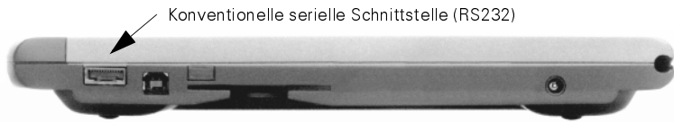
Serielle Schnittstellen für Verbindungen zum PC
