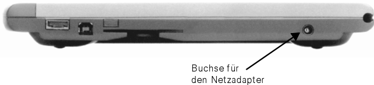
Buchse für Netzadapter an der Geräterückseite
