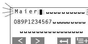
Die Zeile, in der die Einfügemarke steht, blinkt, solange bis die Löschtaste gedrückt oder ein Zeichen eingegeben wurde.
