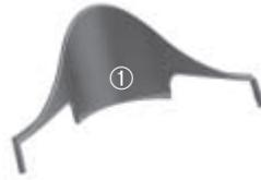
2. Darauf achten, dass der Stützknopfen ① auf der Rückseite des Flügels in den vorgegebenen Schlitz einrastet.
