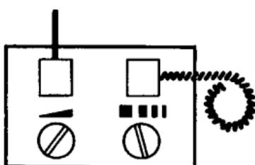
Il segnale di chiamata può essere regolato tramite due manopole che si trovano nella parte inferiore dell'apparecchio.
