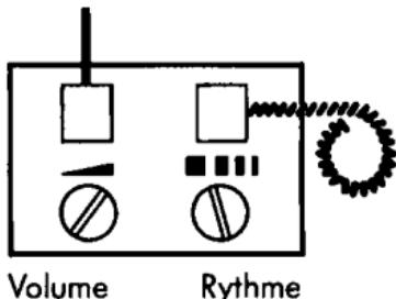
Le signal d'appel peut être réglé à l'aide des deux boutons placés sous l'appareil.
