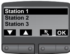
Wählen Sie im Untermenü „**Einstellungen**“ die Menüoption „**Anmelden**“ aus. In der folgenden Displayanzeige werden Ihnen die verfügbaren Basisstationen angezeigt (bis zu 6). Wählen Sie eine Basisstation aus (Empfehlung: Station 1) und bestätigen Sie mit der **OK**-Taste.
