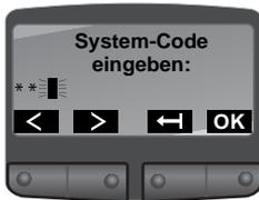
Sie werden aufgefordert, den System-Code der Basisstation einzugeben. Bestätigen Sie die PIN mit der **OK**-Taste.
