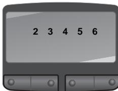
In der darauf folgenden Displayanzeige wählen Sie über die Wahl-tastatur eine der angezeigten, verfügbaren Nummern als Mobilteil-Nr. Erfolgt hier keine Angabe, so wird nach einigen Sekunden automatisch die nächste freie Mobilteil-Nr. gewählt. Wenn anschließend die gewählte Station im Display erscheint, ist Ihr Mobilteil angemeldet.
