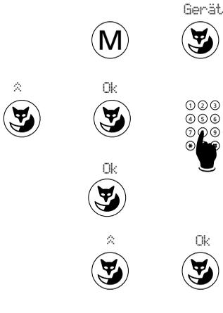
Im Programmiermodus M-Taste so oft drücken bis "Gerät" erscheint und anschliessend die Foxtaste unter "Gerät" drücken; es erscheint "Ausschalten".
