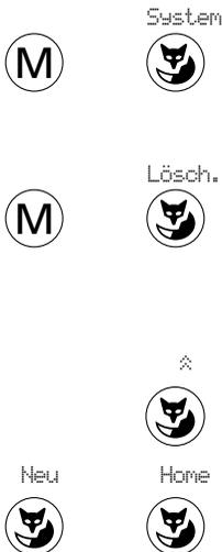
Im Programmiermodus M-Taste so oft drücken bis "*System*" erscheint. Foxtaste unter "*System*" drücken. Im Display wird "*Auto*" oder das aktuelle System (A, B, C oder D) angezeigt.
