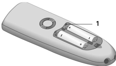
Deckel an der Kante **1** ansetzen und nach unten drücken, bis er einrastet.
