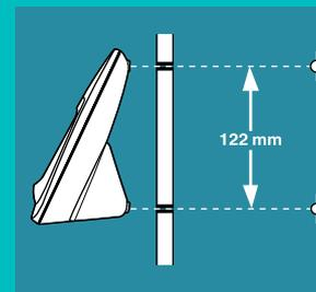
Bohren Sie in einem senkrechten Abstand von 122 mm zwei Löcher in die Wand. Bringen Sie die Dübel und Schrauben (Durchmesser 4 mm) an (nicht enthalten).
