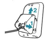
**4** Bringen Sie den Sockel an der Basisstation an, indem Sie die vier Haken in die Aussparungen an der Basisstation positionieren. Schieben Sie den Sockel nach oben, bis er hörbar einrastet.
