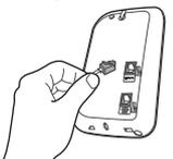
**2** Schließen Sie den Netzstecker (rot) an der entsprechenden Buchse an, die wie folgt gekennzeichnet ist:
