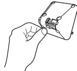
**1** Schieben Sie die beiden Anschlusschnüre durch die auf der Rückseite befindliche Ausbohrung. Ziehen Sie eine ausreichende Schnurlänge durch damit die Stecker gut gehandhabt werden können.
