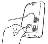
**3** Schließen Sie den Stecker der Telefonanschlusschnur (transparent) an der entsprechenden Buchse an, die wie folgt gekennzeichnet ist:
