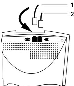
Stecken Sie den kleinen Stecker des Telefonanschlusskabels in die mit
