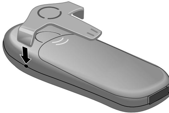
Gürtelclip auf der Rückseite des Mobilteils andrücken, bis die seitlichen „Nasen“ in die Aussparungen einrasten.
