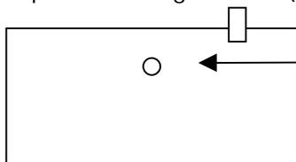
Anmeldetaste an Basisstation Top E514<sup>ISDN</sup> kurz drücken.
