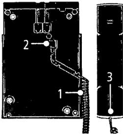
Das spiralförmige Hörerkabel (1) auf der Unterseite des Apparates einstecken (2), durch den Kanal führen und am Hörer (3) einstecken.
