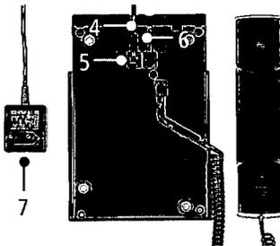
Das Netzkabel (4) auf der Unterseite des Apparates einstecken (5) und durch den Kanal führen (6). Den Netzstecker (7) in die Steckdose einstecken (benützen Sie auf jeden Fall das mitgelieferte Netzteil). Die LED-Anzeige blinkt für kurze Zeit. Vermeiden Sie während dieser Aufstartzeit jede andere Bedienung.
